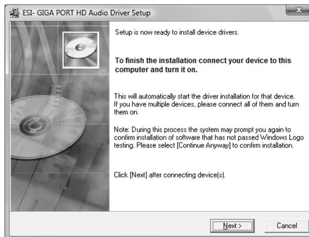
Nun können Sie den *ESI GIGA PORT HD Audio Driver Setup* Dialog mit *Next* bestätigen. Die Installation ist dann abgeschlossen. Um dies zu bestätigen, überprüfen Sie, ob das ESI-Symbol in der Taskleiste (wie auf dem folgenden Bild zu sehen) auftaucht – u.U. ist ein Neustart erforderlich.
