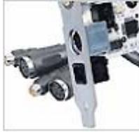
아날로그 입출력 단자뿐만 아니라 동축(코액시얼) 디지털 입력/출력단자와 광(옵티컬) 디지털 출력단자를 지원하여 디지털 기기와 호환이 가능하며 기존 PCI 레코딩카드에서는 지원하지 않던 MIDI 인터페이스(1In/1Out/16ch)가 장착되어 있어 추가적인 비용 및 불편한 설치작업 없이도 간편하게 MIDI 기기와 접속할 수 있는 뛰어난 접속성의 PCI 오디오카드입니다.
