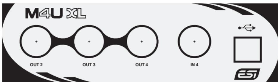
Auf der Rückseite befinden sich 3 MIDI Ausgänge (OUT 2 bis OUT 4) sowie ein MIDI Eingang (IN 4). Im rechten Bereich befindet sich der USB-Anschluss, der dem mitgelieferten Kabel mit dem Computer verbunden wird.
