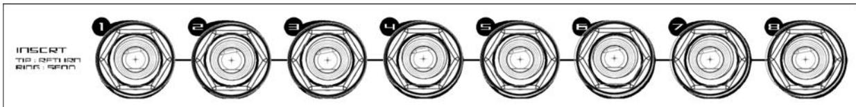
**15** Analoge symmetrische TRS Ausgangsanschlüsse
