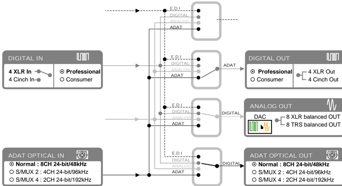
[MODE 4] ermöglicht es Ihnen, das EX8000 als AES/EBU nach ADAT und ADAT nach AES/EBU Konverter zu verwenden. Das Signal der 4 AES/EBU Eingänge wird über den 8 Kanal ADAT Ausgang gesendet. Das Signal vom 8 Kanal ADAT Eingang wird über die 4 AES/EBU Ausgänge gesendet.
