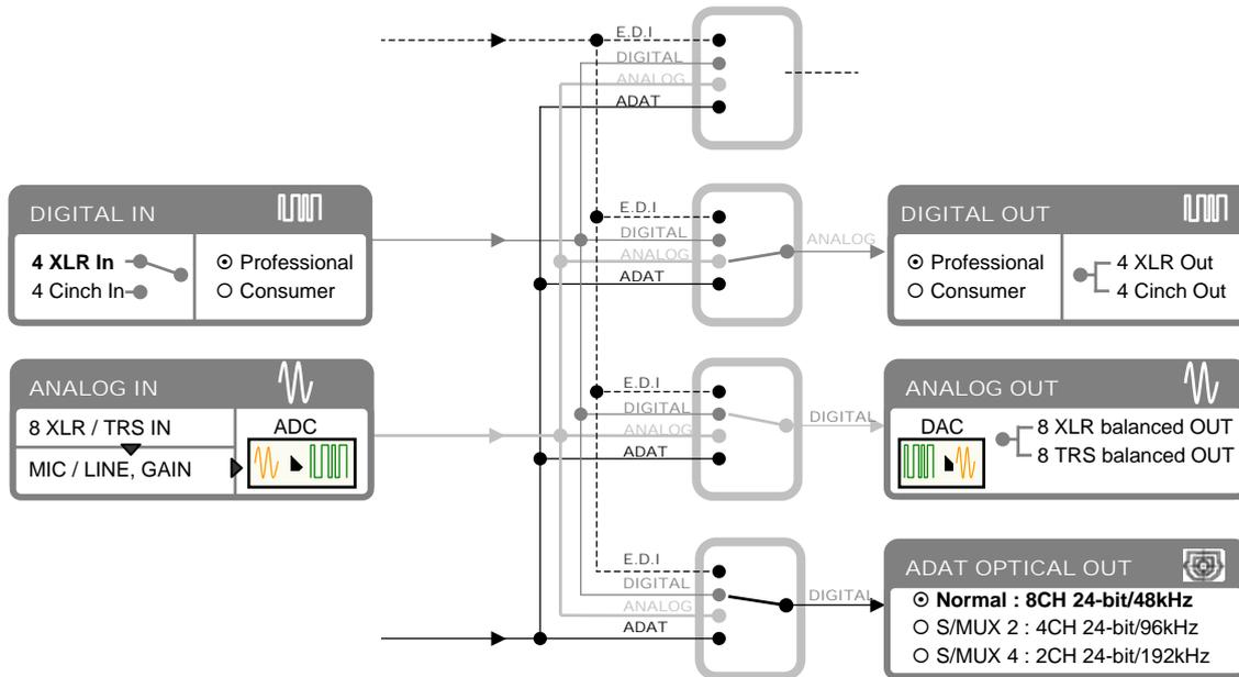
[MODE 1] ermöglicht es Ihnen, EX8000 als 8 Kanal AD-Konverter mit 4 AES/EBU Ausgängen und gleichzeitig als 8 Kanal DA-Konverter mit 4 AES/EBU Eingängen zu verwenden.
