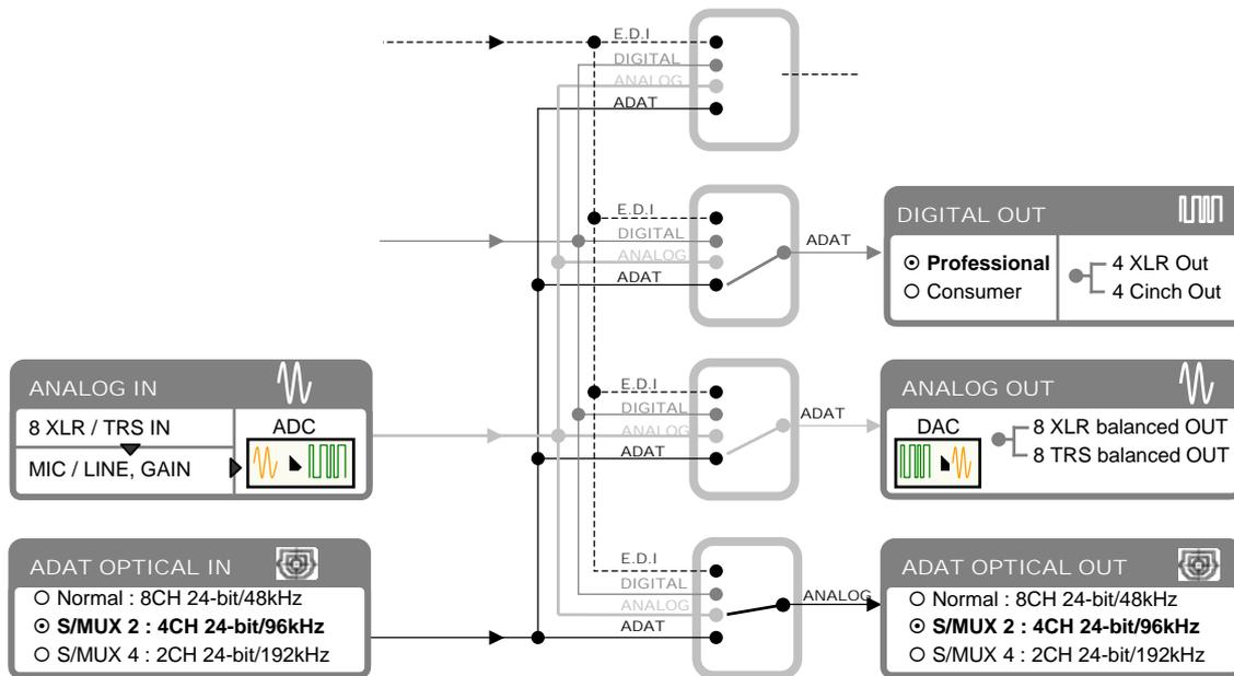
[MODE 6] gleicht [MODE 5] mit den Unterschied, dass S/MUX aktiviert ist. D.h. das nur 4 anstatt der 8 Kanäle übertragen, aber die unterstützte Samplerate doppelt so hoch ist. [MODE 6] arbeitet somit nur mit 88.2 kHz oder 96kHz.
