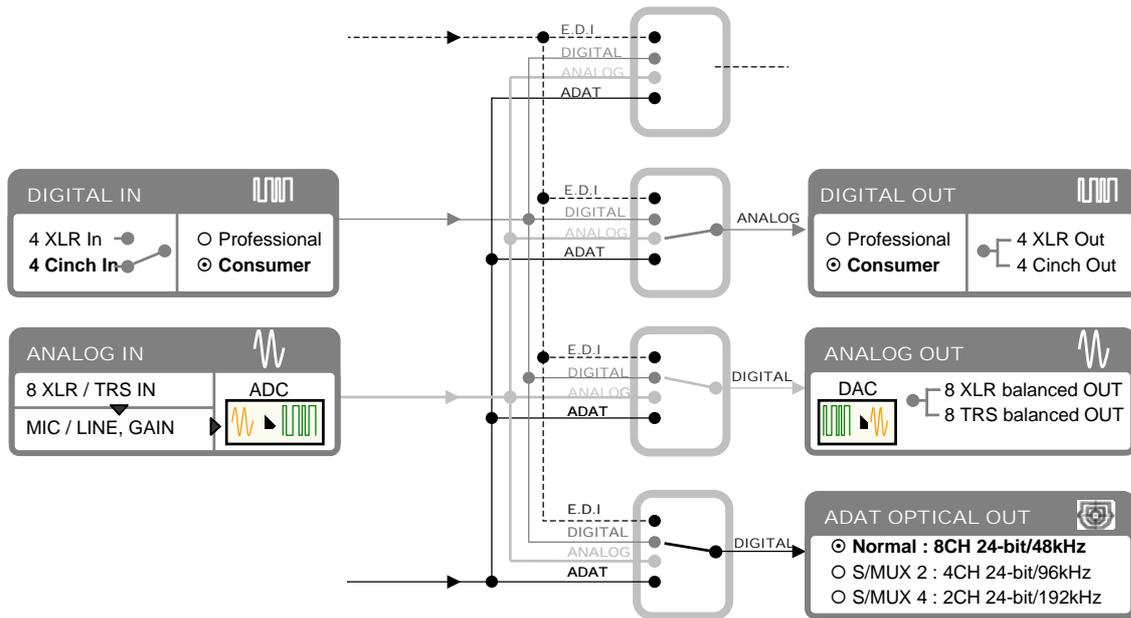
[MODE 2] ermöglicht es Ihnen das EX8000 als 8 Kanal AD-Konverter mit 4 S/PDIF Ausgängen und gleichzeitig als 8 Kanal DA-Konverter mit 4 S/PDIF Eingängen zu verwenden. Da ist ähnlich dem [MODE 1], nur das die digitalen I/O (Ein-/Ausgänge) im [MODE 2] ein S/PDIF Signal und nicht wie im [MODE 1] ein professionelles AES/EBU Signal verarbeiten.
