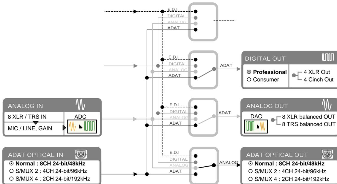
[MODE 5] ermöglicht es Ihnen, das EX8000 als 8 Kanal AD-Konverter mit optischen ADAT Ausgang und gleichzeitig als 8 Kanal DA-Konverter mit optischen ADAT Eingang zu verwenden. Das erlaubt es Ihnen das EX8000 als Standalone AD und DA Konverter mit jedem ADAT kompatible Gerät wie z.B. einen Digitalen Mischer oder ein ADAT Mehrkanalrekorder zu verwenden. Der [MODE 5] arbeitet nur mit 44.1kHz oder 48kHz (verursacht durch die ADAT Formatbeschränkung).
