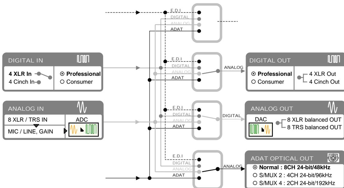
[MODE 3] gleicht [MODE 1] mit den Unterschied, dass der optische ADAT Ausgang zusätzlich ein 8 Kanal Signal vom AD-Konverter sendet. Das ermöglicht es Ihnen, den EX8000 als 8 Kanal ADC mit Mikrofonvorverstärkern und Anschlüssen als ein Gerät mit optischen ADAT-Eingang zu verwenden.
