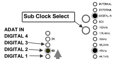
Beispiel: Das Bild oben zeigt, das EX8000 arbeitet mit einem System Takt von 48kHz, gespeist vom AES/EBU Eingang 2 mit Audio Routing [MODE 1].
