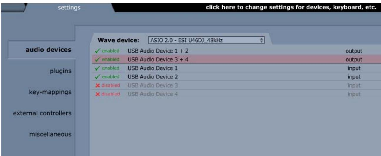
**Du fait des limitations des pilotes de l'USB 1.1, les sorties à 48 kHz sont limitées à 4 canaux. Si vous avez besoin d'une qualité audio supérieure et que vous n'avez pas besoin des 6 sorties vous pouvez choisir la fréquence d'échantillonnage de 48 kHz. Mais si votre travail nécessite 6 sorties vous devez choisir 44.1 kHz.**
