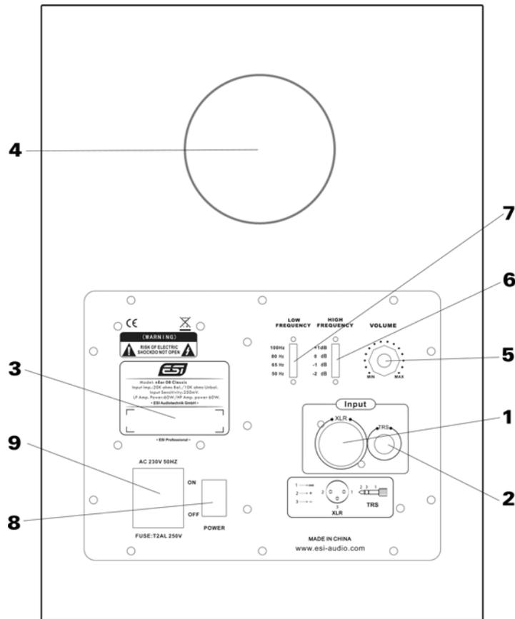
**1. XLR-Eingang** – dieser Anschluss ermöglicht die Verbindung Ihrer Quelle über symmetrische XLR-Kabel. Die Pinbelegung:
