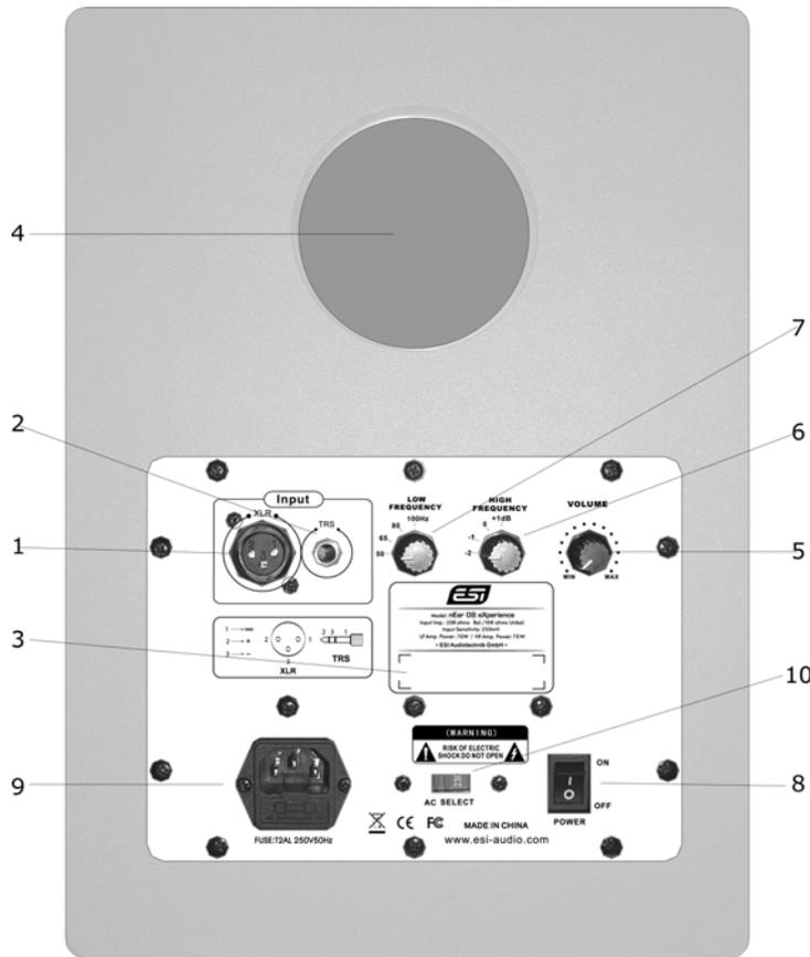
**1. XLR-Eingang** – dieser Anschluss ermöglicht die Verbindung Ihrer Quelle über symmetrische XLR-Kabel. Die Pinbelegung:
