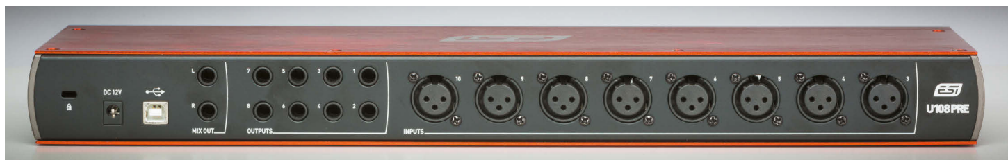
Die Rückseite beherbergt ein reichhaltiges I/O inklusive dediziertem »Mix«-Ausgang
