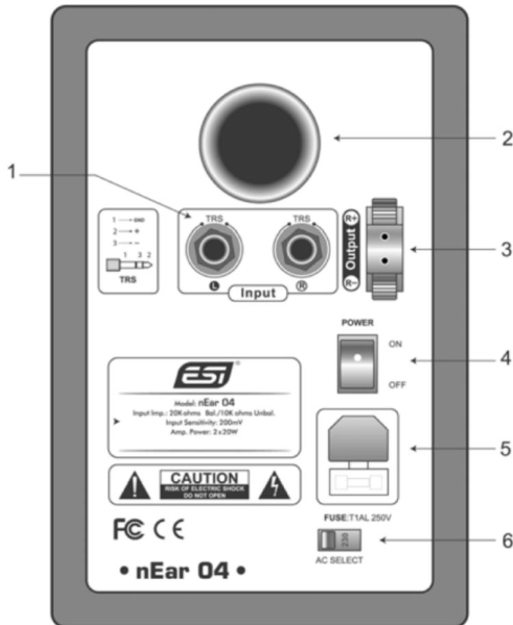
**1. Klinkeneingang** - dieser Anschluss ermöglicht die Verbindung Ihrer Quelle über symmetrische (3-polige) oder unsymmetrische (2-polige) Klinkenkabel. Die Pinbelegung:
