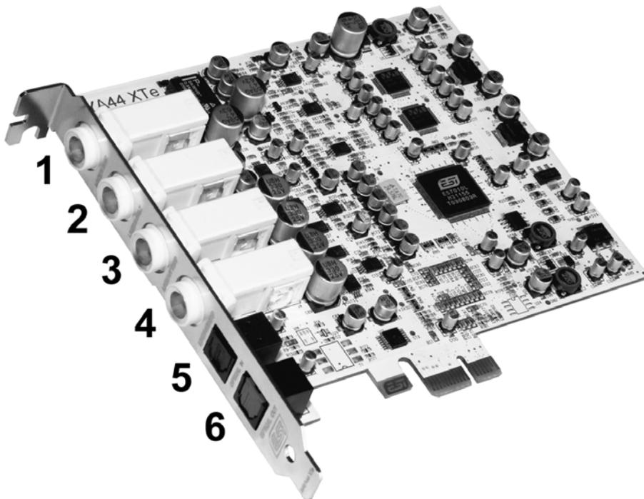
1. **INPUT 1/2:** analoger Line-Eingang (Stereo) / Mikrofon-Eingang (Mono)
