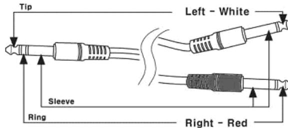
Die Spitze des Stereo-Klinkensteckers ist mit der Spitze des Steckers des linken Kanals verbunden, der Ring des Stereo-Klinkensteckers mit der Spitze des Steckers des rechten Kanals. Die Hülse (mit Masse) ist zwischen Stereo-Klinkenstecker und beiden Mono-Steckern durchverbunden.
