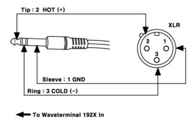
Waveterminal 192X's output port use Y cable (stereo  $\leftrightarrow$ mono x 2).
