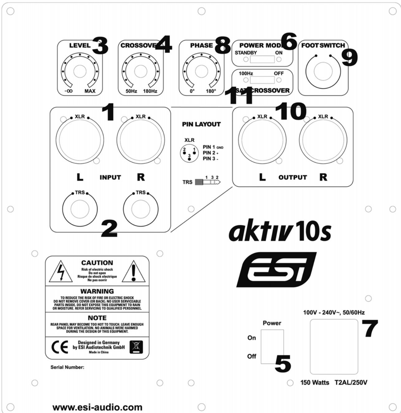
**1. XLR-Eingänge** – dieser Anschluss ermöglicht die Verbindung Ihrer Quellen über symmetrische XLR-Kabel. Die Pinbelegung:
